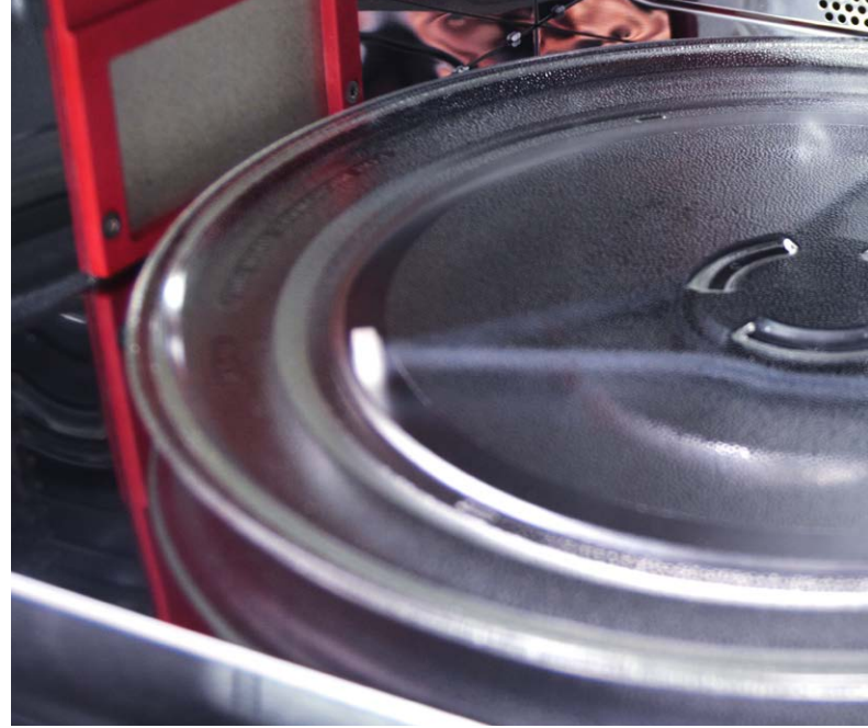
Mit der Drehteller-Stop -Taste kann man die Rotation auch ausschalten, um bspw. ausladendes Geschirr, welches an den Innenwänden anstoßen würde, zu verwenden.
